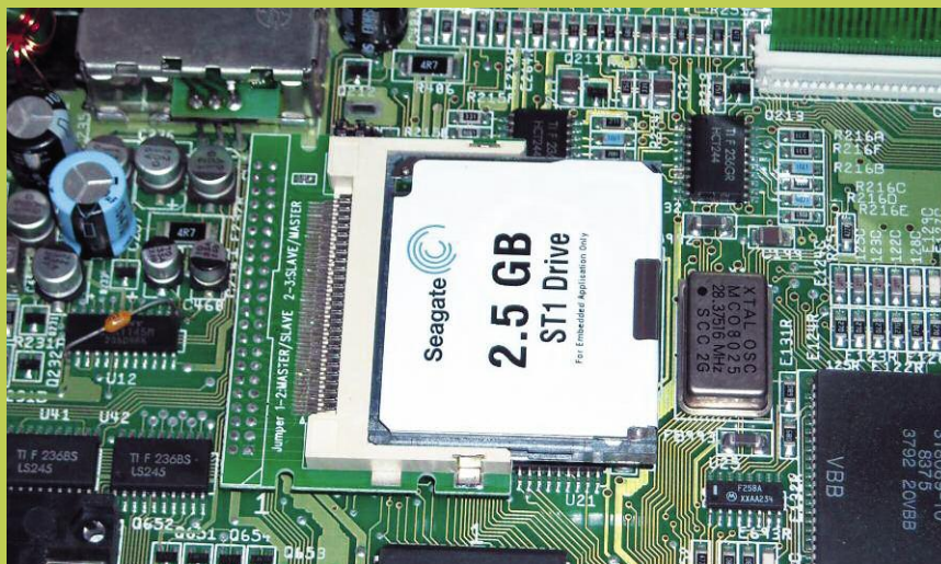
Szalagkábel mentes CF-IDE adapter egy 2,5 GByte-os Microdriveval
