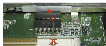
■ Kép 9.: Zárlat ellen szigetelőszalag
