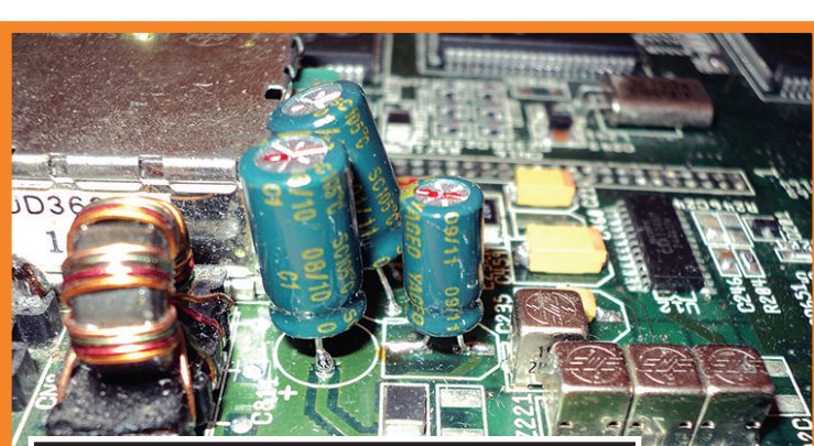
A belső tápellátás kijavítva, furatszerrelt és SMD tantál kondikkal
