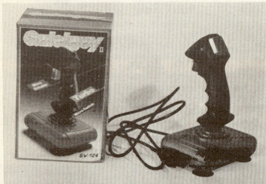
1. Mikrokapcsolós joystick Ára: 1300 Ft négy mikrokapcsolóval, két tüzelőgombbal, AUTO FIRE-ral rendelkező joystick.
