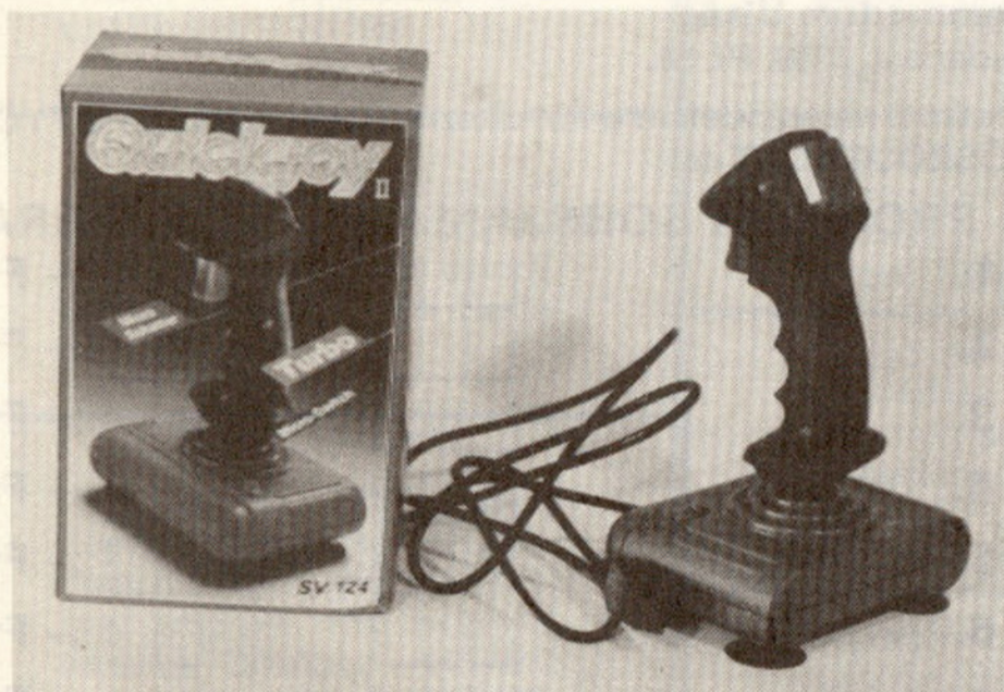
1. Mikrokapcsolós joystick négy mikrokapcsolóval, két tüzelőgombbal, AUTO FIRE-ral rendelkező joystick. Ára: 1300 Ft
