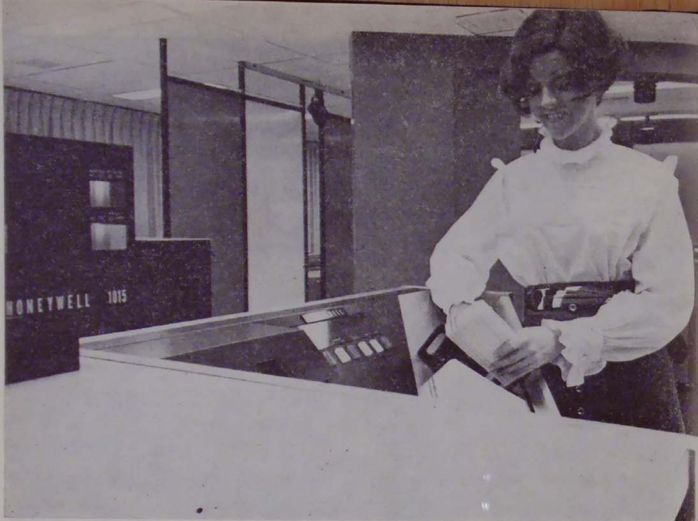
A Honeywell Modell 1015 a második új számítógép a 200-as sorozathoz tartozó gépesaládon belül. A berendezés a 200-as sorozat kisebb számítógépei használóinak az olvasó multiprogramozás lehetőségét nyújtja. Havi bérleti díja 8000 és 18 000 dollár között van. Az 1015-ös berendezés ciklusideje 1,6 mikrosec. Mágnesmagos tárolójának kapacitása 131 072 karakter. A berendezés az OS/200 operációs rendszerrel dolgozik.
