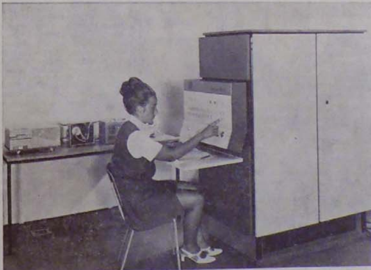
PRS 4000 folyamatvezérlő számítógéprendszer - R 4000 számítógép, lyukszalagegység
