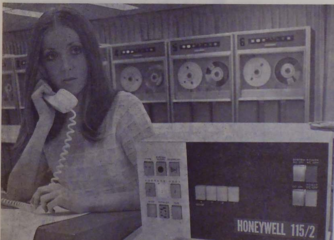
A Honeywell-Bull cég új, 115/2 jelű klisszámítógépe. A gép ciklusideje 2,25 microsec, ferritgyűrűs tárolójának kapacitása 85 536 karakterig bővíthető. Perifériális berendezéseit integrált vezérlőrendszer irányítja.
