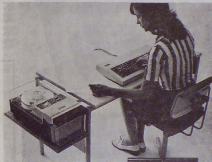
A svéd Facit cég 6205 típusú lyukszalagos adatrögzítő berendezését speciálisan fényeszedőgépekhez fejlesztették ki.
