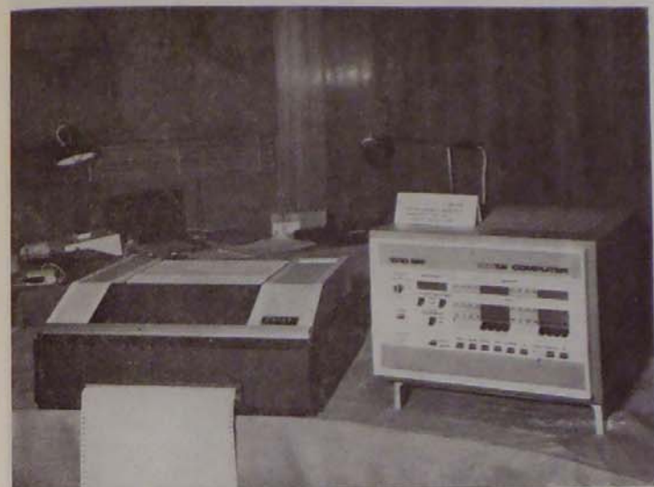
A „Tally 2000” sornymatató család 2100-as modellje, a VIDEOTON 1010 BM kis-számítógéppel összekapcsolva.
