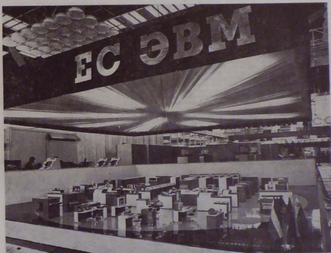
ESZR berendezésekből felépített nagy számítóközpont makettje (ESZR 2050 és 2030 központi egységek és nagyszámú különböző periféria).
