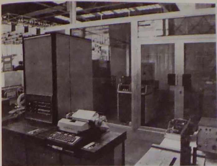
Az ESZ 1010 (R-10) magyar kisméretű számítógép sokperifériás konfigurációja. A háttérben, az üvegfalú kis klimatizált fülkében, az alsó részhez kapcsolt bolgár gyártású mágneslemezes tároló egységek.
