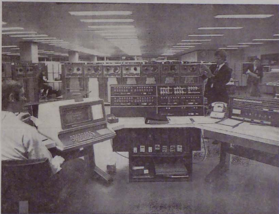
A Univac 494 real-time rendszer számítógéppontjának részlete. Előtérben a Uniscope 300 képernyős konzolrögzítő (baloldalt), a kijelző mezők (középen) és a real-time óra (jobboldalt). A háttérben a Uniservo VIII C mágnesszalagos egységeket lehet látni.
