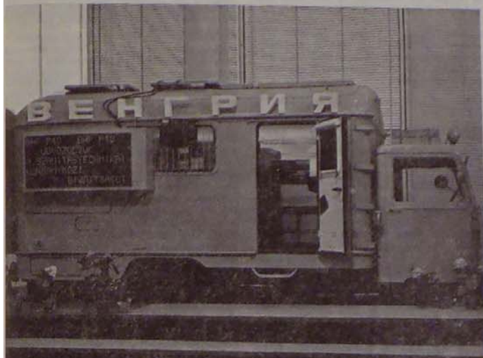
Az ESZ 1010 kisszámítógép terepjáró gépkocsiba épített változata mindenféle helyszíni mérésadat-feldolgozásra alkalmas.
