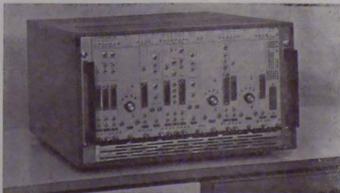
KFKI-CAMAC: számítógéppel összekapcsolt moduláris mérő- és vezérlőrendszer.
