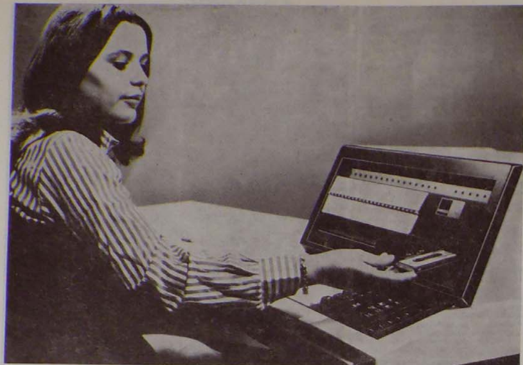
Decentralizált adatgyűjtésre szolgál a Kienzle 1100 terminál. A berendezés az alfanumerikus billentyűzet útján bevitt adatokat 3,51 mm szélességű kazettás mágnesszalagon rögzíti. Az adatok helyessége sorkijelzőn ellenőrizhető.
