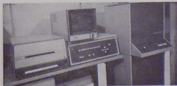
A Kongsberg Vapenfabrik (Norvégia) DC 300 rajzrészletvezérlő rendszere VERIFAST képernyővel és másolóegységgel a rajzprogramok gyors ellenőrzésére
