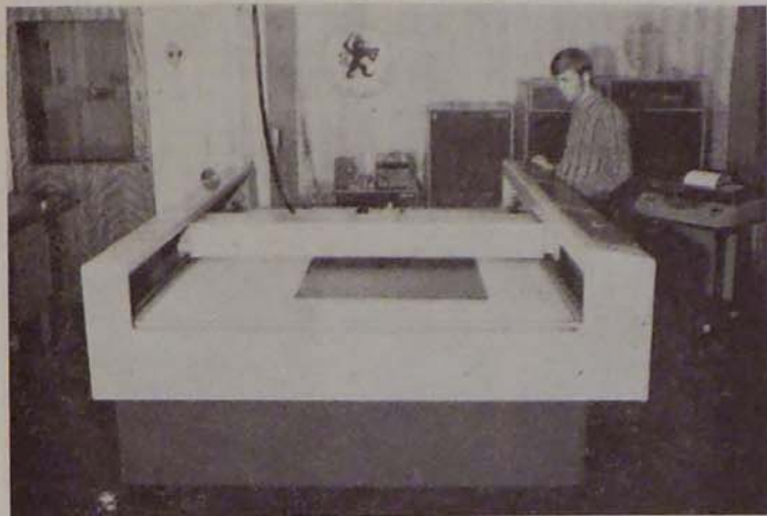
A gőteborgi Várostervezési Hivatalban használt DS 300/1251 berendezés (előtérben a rajzasztal, hátul a vezérlőegység)
