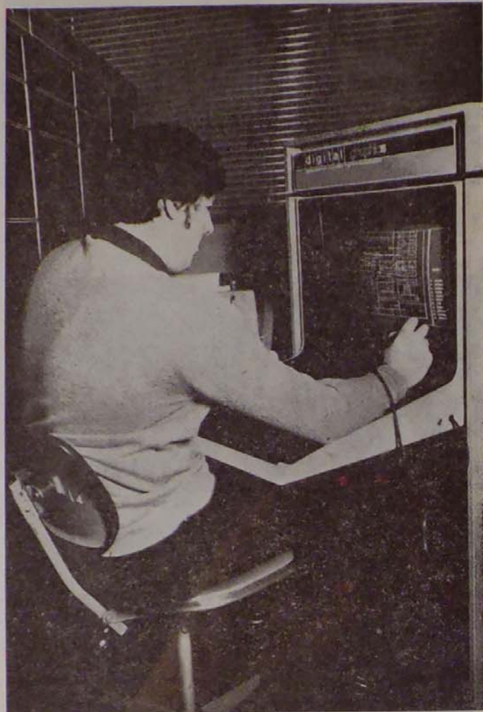
Nyomatott áramkörök tervezésére szolgáló berendezés. A programot PDP 15-ös digitális számítógépen futtatják
