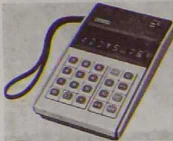
2. kép. A Sharp ELSI 811 típusú japán zsebszámológép
