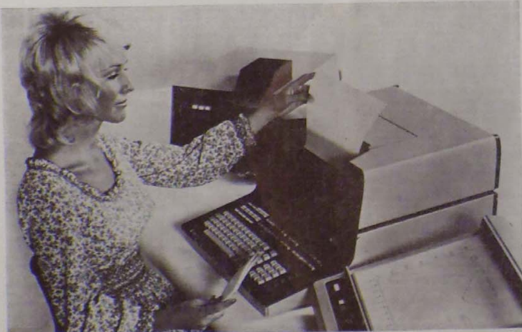
6. kép. A korszerű programozható elektronikus számológépek felhasználási lehetőségeit különféle perifériális berendezésekkel lehet növelni. (Hewlett-Packard 9800 30)
