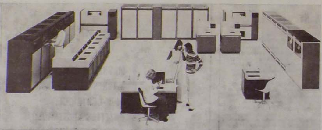
Az UNIDATA 7750-es nagyberendezése, amely adatfeldolgozó hálózatok és adathank rendszerek központi számítógépeként is használható.
