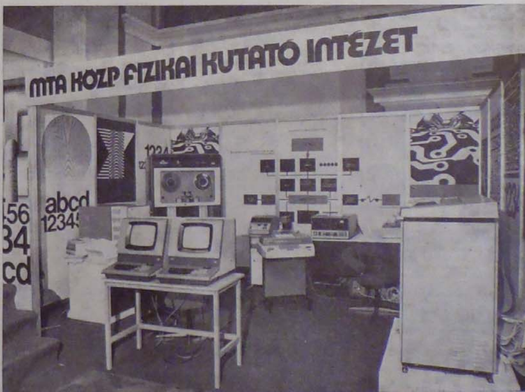
Intelligens terminálként működött egy TPA-1 kismámítógép a KFKI standján. Háttérben a ZMB-61-1 típusú mágnesszalagos tároló látható.
