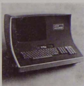
Consul 920 jelű terminál, 24 soros, soronként 80 karaktert megjelenítő képernyővel (Applied Digital Data Systems Inc.)
