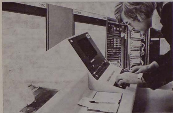
A szétteső UNIDATA egyesülés 7000-es sorozatának max. 2018 Koye tárkapacitású 7750-es típusú legnagyobb berendezése
