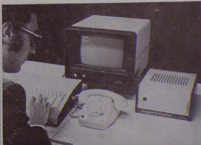
A Siemens új, 1200 A modellével távbeszélővezeteken keresztül, 1200 bit/s-ig terjedő sebességgel vihetők át az adatok. Az eszköz még egy második sebesség-tartományal is rendelkezik, amely csak maximálisan 600 bit/sec-ig terjed, viszont keskenyebb frekvenciasávot igényel, hogy erősen populáris vezetéken keresztül is képes legyen átvitelt biztosítani.
