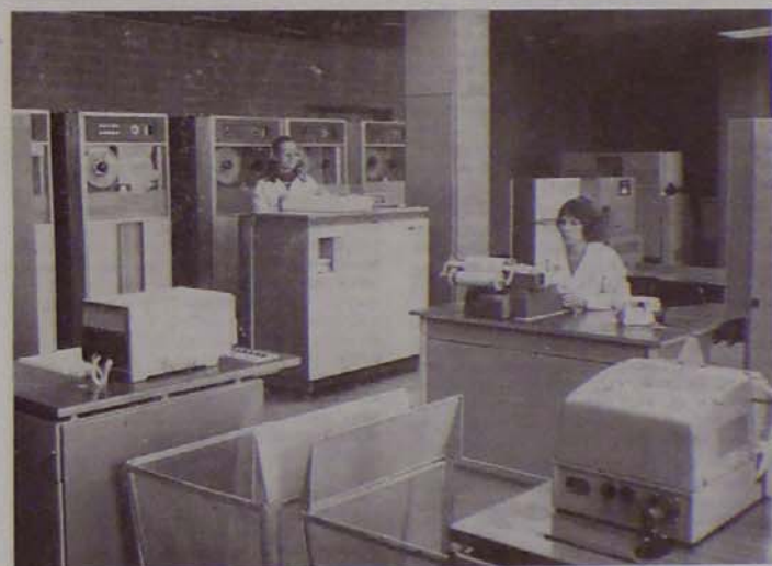
A szovjet M-4030 típusú folyamatvezérlő számítógép működés közben. FOTO: R. ALFIMOV, APN.
