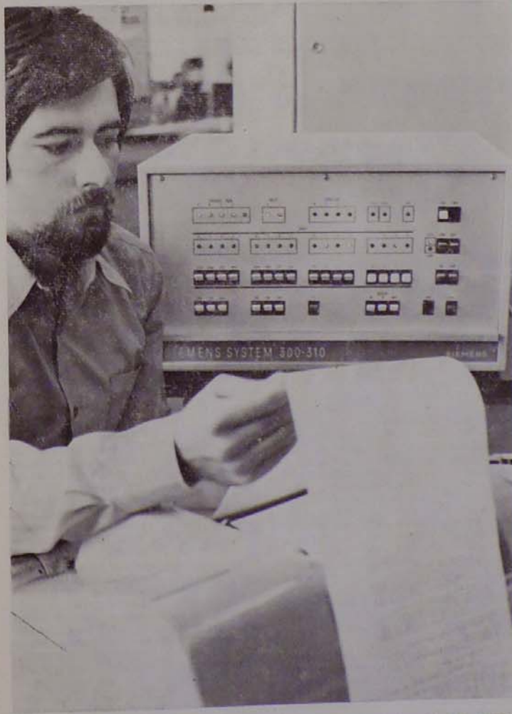
A Siemens bemutatta 810-es típusú folyamatszabályozó számítógépszerzőt, amelyhez — adott egyszerűbb vagy bonyolultabb szabályozástechnikai feladatok ellátására — megfelelő központi egységeket (310D és 310S) fejlesztettek ki.
