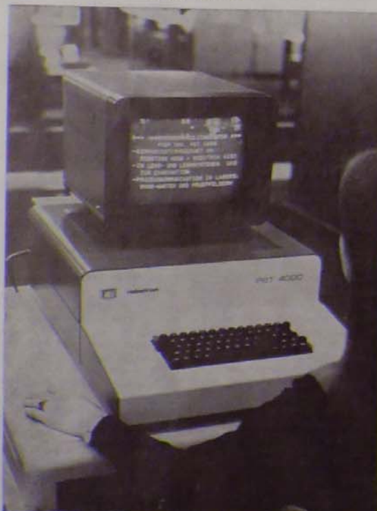
A Robotron egyik új terméke, a PBT 4000 programozható display terminál
