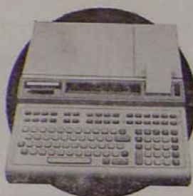
HP 9825 – A megszámlálási rendszer és az „elő” billentyűzet lehetővé teszi, hogy – kívánság szerint akár egyidőben – vezérel, rendez és kiszámítja az adatokat. Igen gyors. A belső tár 32 KByte-ig bővíthető. A gyors mágnesszalag egység 250 KByte-ot rögüt. Konzervatív programnyelv és széles körű illesztési lehetőség.
