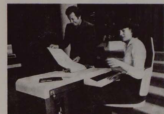
A Triumph/Adler TA 22-es adatrögzítő rendszere hajlékonylemez tárolót alkalmaz adathordozóként.
