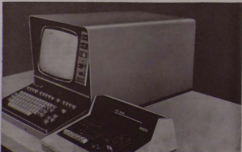
A központi számítógéppel telefonvonal és modem közbeiktatásával a VTS-56100-as terminál segítségével tudunk kapcsolatot létesíteni.
