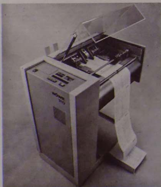
BÖWE 310-es vágóautomata kétféle sorreléssel készülő laporellőkhöz. Teljesítménye 25 000 úrlap/óra
