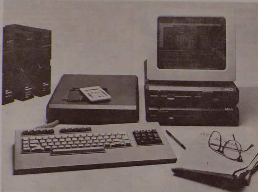
Egy Európában még alig ismert kaliforniai cég, a MAD (Modular Advanced Design) mikrogepe a Computer City standjának egyik szenzációja volt. A 256 kb-ji alapképzésű, 16 bites, MS-DOS és konkurrens CP/M alatt futó, színes grafikával és gazdag alkalmazói szoftverrel ellátott rendszer kompatibilis az IBM PC-vel.
