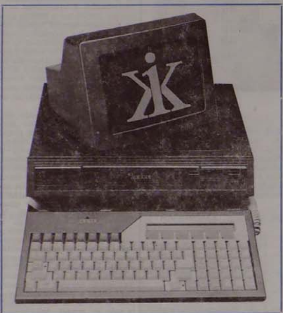
A legújabb Apricot XI csúcs-mikroszámítógép: 256—768 kb-át központi tárral, 10 Mb-át kapacitású winchesterlemez egységgel és 3,5" mikrohajlékonylemezes egységgel (720k)
