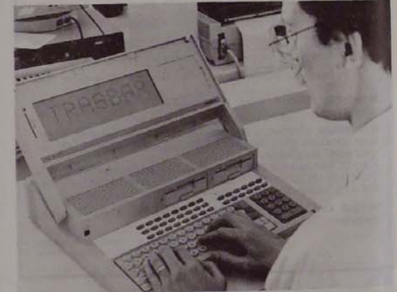
A Siemens PC 16-07 hordozható személyi számítógép 256-512 kb-át központi tárral, két hajlékonylemez egységgel rendelkezik, CP/M operációs rendszerrel működik. Siemens-fotó
