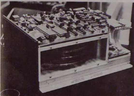
A MOM winchester-elyű mikrotrórolójának mintapéldánya Fotó: Stefkó Lajos
