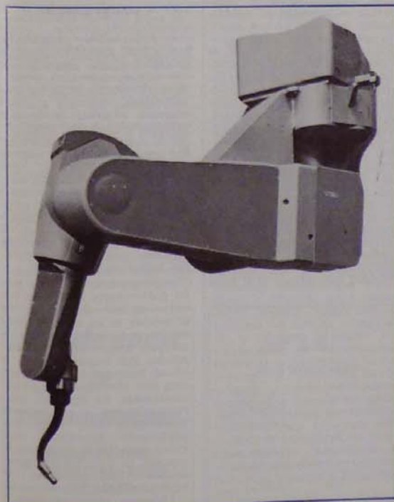
Az osztrák Tomch-Electronics cég MEMOSOLD forrasztórobotja
