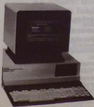
Az első hazai, IBM PC/AT-vel kompatibilis mikrogép, a Proper 16/MT, az SZKI gyártmánya
