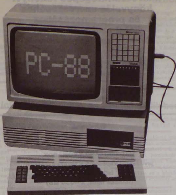
A csehszlovák Tesla gyárnak az IBM PC/XT-vel kompatibilis PC88 típusú mikrogépe
