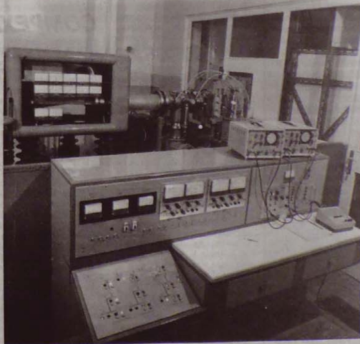
A KFKI-ban 1972—73-ban kifejlesztett ionimplantáló berendezés (Pásztor E. és munkatársai)
