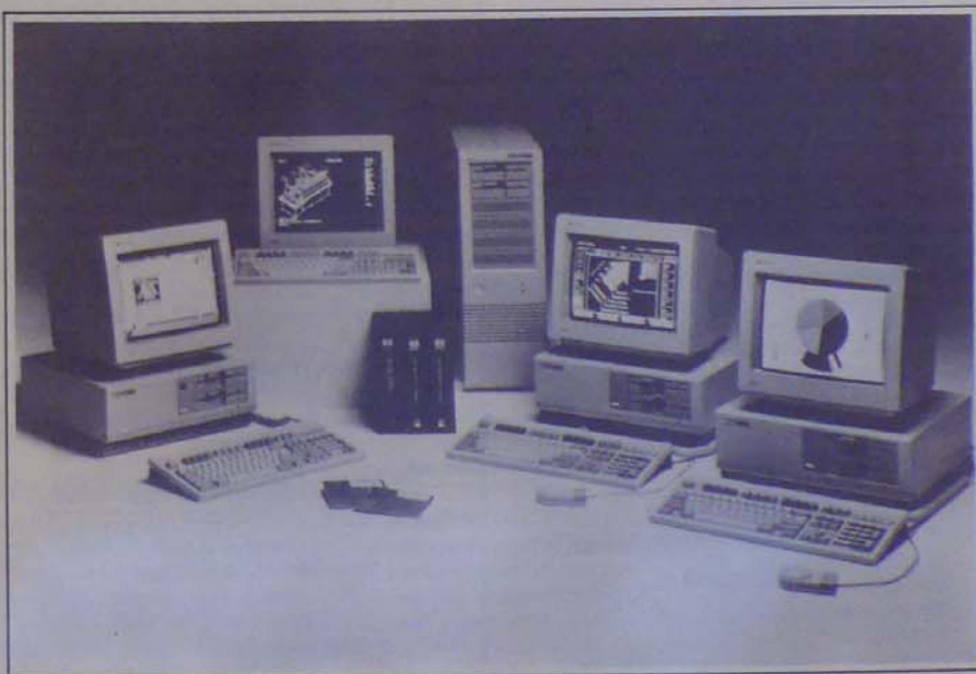
A HP Vectra gépcsalád balról jobbra: Publisher PC, RS PC (a legnagyobb teljesítményű családtag), ES PC (teljesítménye megegyezik az IBM PS/2 Model 60-éval), végül a legkisebb, a CS PC
