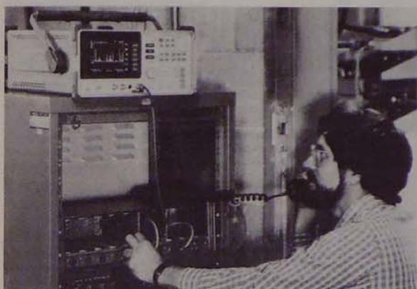
A HP 8590A 13,5 kilogramm tömegű, hordozható nagyfrekvenciás spektrumanalizátora adatátviteli berendezések vizsgálatához
