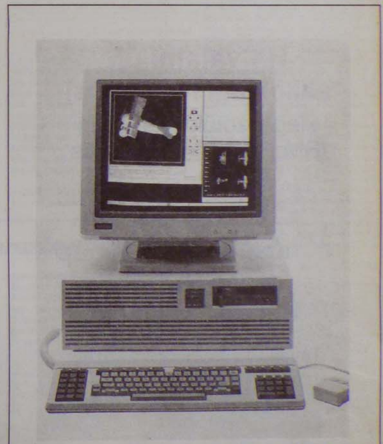
A Siemens MX 300-as munkaállomását Sinix operációs rendszer vezérli, központi tára 8—16 megabájt, és maximálisan 12 képernyős terminál csatlakoztatható hozzá
