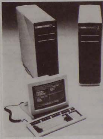
Nixdorf-Quattro négy párhuzamos processzorral, 1 gigabájt lemezkapacitással mesterségesintelligencia-alkalmazásokhoz
