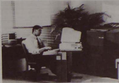
CDC Cyber 960 virtuális tárkezeléssel, irodaautomatizálási feladatokhoz. 1989-től UNIX alatt is fut majd
