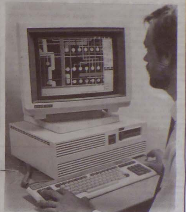
Sístest 300 számítógépes munkahely elektronikus áramkörök fejlesztéséhez, tervezéséhez és ellenőrzéséhez. A hálózathoz köthető rendszert a Siemens szállítja.
