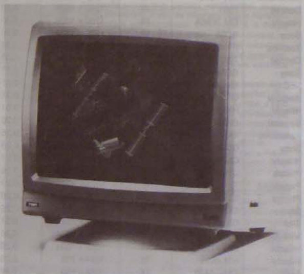
Conrac 7351 nagy felbontású megjelenítő. Az ergonómiai szempontok figyelembevételével tervezett készülék felbontása 1280 x 1024 képpont. A 19 inches képsővel felépített berendezés villogásmentes képet ad, ugyanis a sorkfrekvencia 65 kilohertz, a megjelenítés nem váltott soros. A videojel sávszélessége 110 megahertz, a színes képpontok mérete 0,31 milliméter. A CAD/CAM/CAE célokra kiválóan alkalmas professzionális megjelenítő kontrasztátfogatását növelték. Az automatikus öntesztelés eredményeként a működési paraméterek betartását világító diódák jelzik
