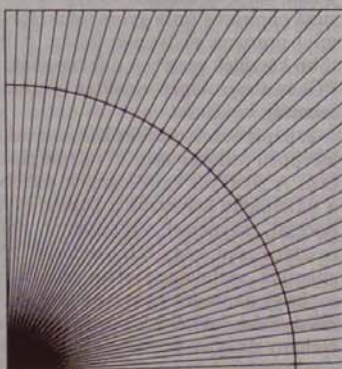
Az ábra a rajzolási és visszaállási pontosság, a felbontás és a vonalegyenesség vizsgálatára alkalmas
