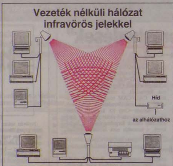
A Photolink infravörös fényvel oldja meg az adattovábbítást helyi hálózatok számítógépei, vagy a hálózati erőforrás és a terminálok között
