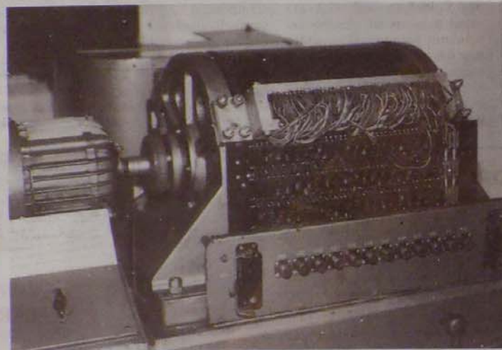
Az Ural-2 számítógép mágnesdobos tárolója. A dob forgatását meglehetősen robusztus motor végezte. A tároló kapacitása 32 zónában, zónánként 512 felszó, vagyis összesen 16 384 felszó
