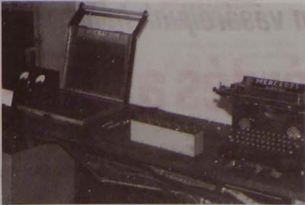
A Budapesti Műszaki Egyetemen készült digitális számítógép, a MESZ-1 (Műszaki Egyetem Számítógépe-1) vezérlőpanelje, balra a jelfogókat tartalmazó szekrény. A műveletek programját celluloidlapra lyukasztották, és az adatokat, valamint az eredményeket relés tároló őrizte meg. A kiírást egy átalakított Mercedes írógéppel oldották meg
