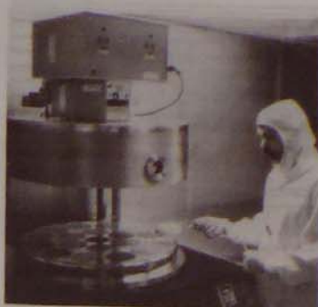
Plazmamaratás; gáziplama segítségével rajzolják fel a szilíciumlapka felületére a legbonyolultabb struktúrákat
