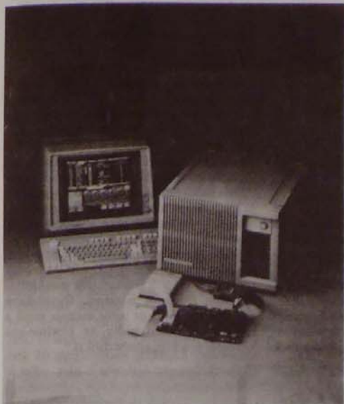
Több mikroprocesszort is tartalmazó digitális analízáló a DAS9250
