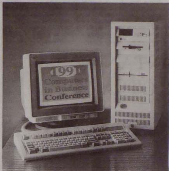
A legnagyobb teljesítményű PS/2. A Model 95XP hat szabad 32 bites bővíthellyel rendelkezik és öt merevlemez számára biztosít helyet. A Model 90-hez hasonlóan SCSI vezérlővel és cserélhető CPU-kártyával szerelték fel. Erre a gépre kívánja építeni az IBM rövidesen piacra kerülő többprocesszoros szuper kiszolgálóját
