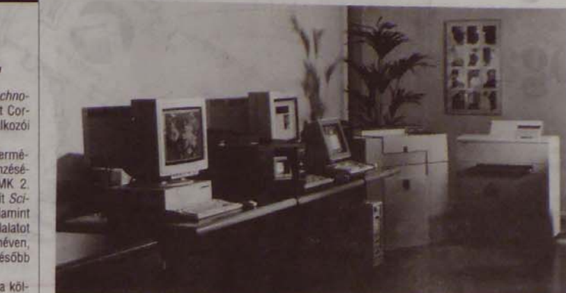
IPSO-1 , közepes nagyságú PostScript-rendszer, amelyben Macintosh II-alapú szövegszerkesztő rendszert, SmartTwo PS színes scannert és Dolev PS nagy felbontású színes PostScript levilágítót integráltak
