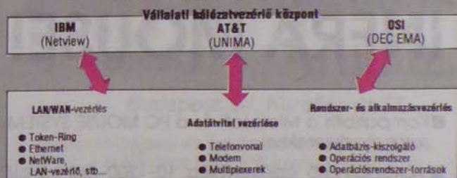
A PROTEON elképzelés a kétszintes hálózatvezérlő rendszerekről IBM-, AT&T- és DEC OSI-kompatibilis megoldások esetén
