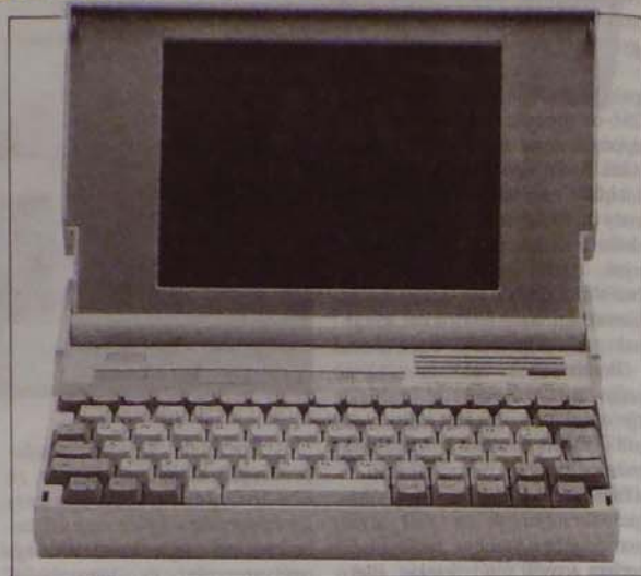
Az SNI PCD—2N notesze (80C286-os processzor, 40 megabájtos háttértár, 9 inches VGA képernyő)
