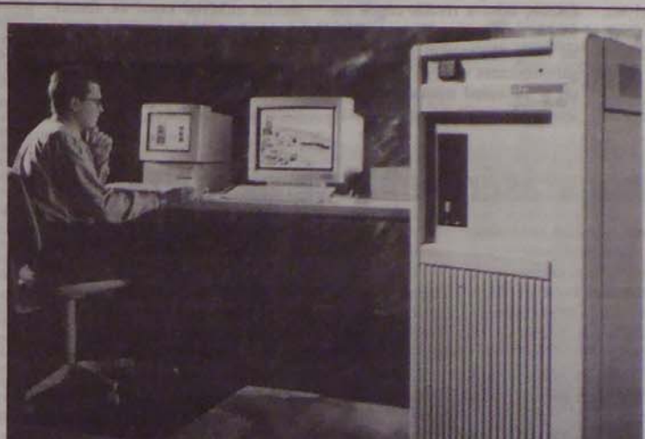
A Linotype—Hell Macintosh- és PC-alapú DTP rendszerekhez egyaránt ajánlja RIP 60 típusszámú PostScript-berendezését. A színeskép-technológiában régről nagy nevet szerzett Hell ezzel az eszközzel jelenik meg először a DTP-piacon. A RIP bármely Linotype levilágítóhoz alkalmazható.
