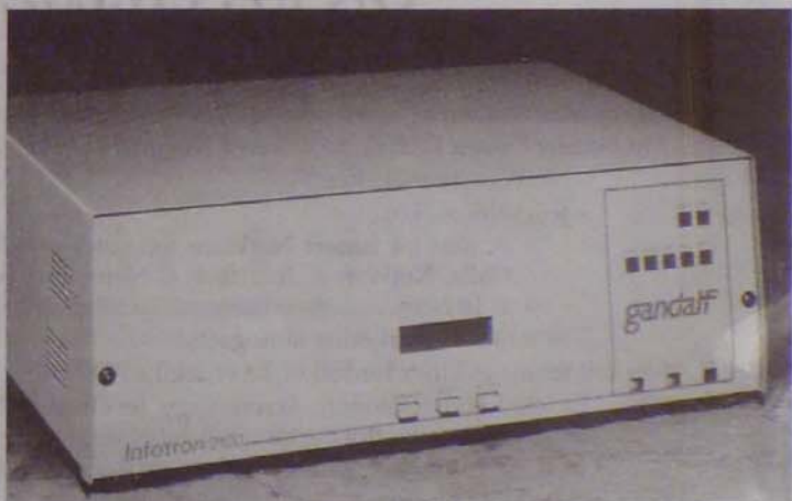
Infotron 2120-as koncentrátor LAN-ok számára — a nagy kiterjedésű hálózatokra jellemző sávszélesség és teljesítmény a multimédia-átvitelt is lehetővé teszi
