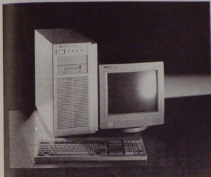
A HP UNIX-alapú kiszolgálósaládjának belépő szintű tagja: HP 9000 Model E25
