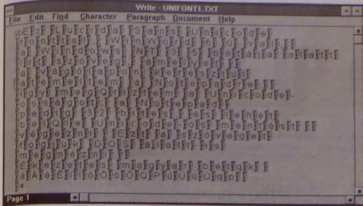
3. kép. A 2. kép szövege a Windows for Workgroups 3.11 nyolcbites Write-jával: e karaktereknél így néz ki a második bájti. (Ugyanezek helyén DOS-ban ^@ áll.) Hasonló elme-nyeket szereshetünk Unicode-os alkalmazások belső szövegeinek 8 bites olvasásakor is
