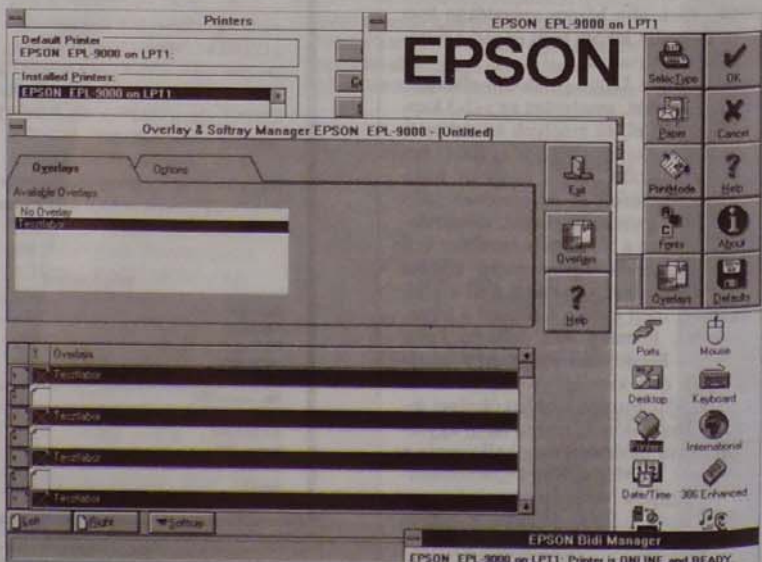
2. ábra. Windowsos meghajtóprogramjának két újdonsága az állapotsor a képernyő alján és az ismétlődő oldalelemek tárolása, majd automatikus nyomtatása
